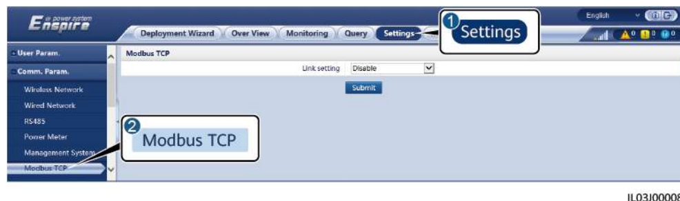
Figure 6-41 Setting Modbus TCP parameters
