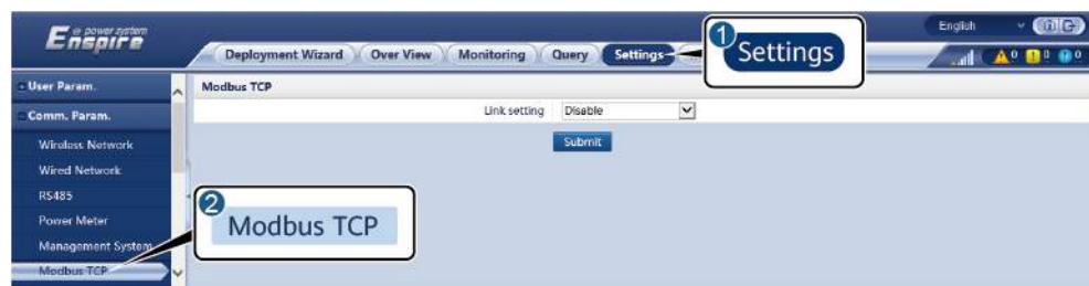
Figure 6-34 Setting Modbus TCP parameters
