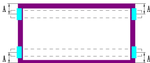
Na krátké straně použijte 4 svorky. Montážní lišty jsou rovnoběžné s dlouhým bočním rámem.
