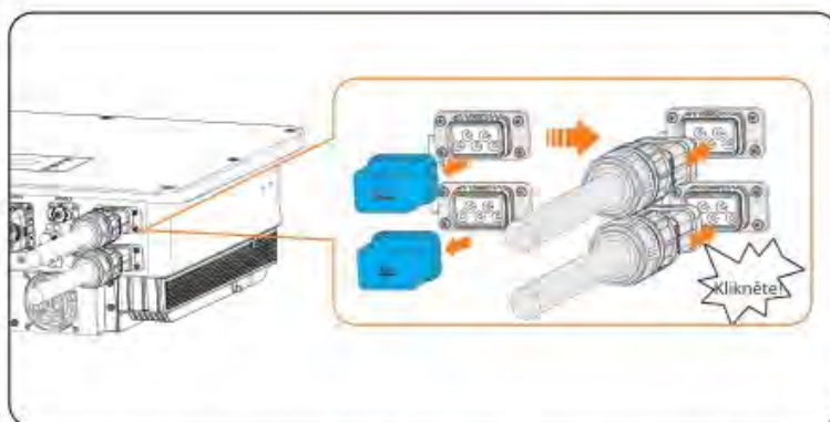
Obrázek 8-13 Instalace AC konektoru do inverteru
