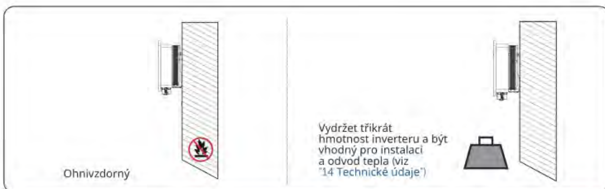
Obrázek 5-3 Požadavek na instalační nosič
