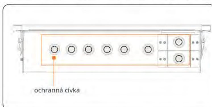
Obrázek 15-25 Odstranění ochranné cívky
