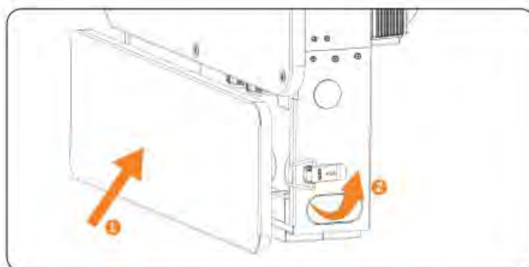
Obrázek 15-38 Instalace předního panelu
