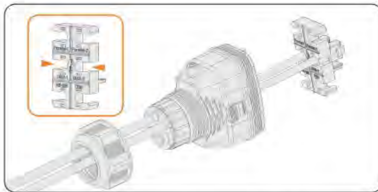
Obrázek 8-42 Instalace RJ45 terminálu k upevnění kabelu
