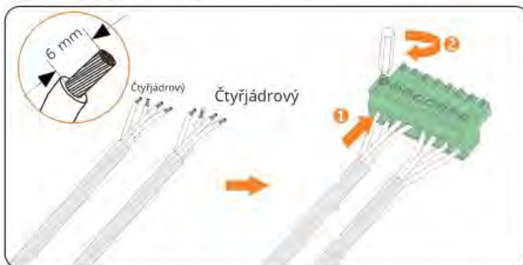
Obrázek 8-61 Připojení k 8-pinovému terminálu
