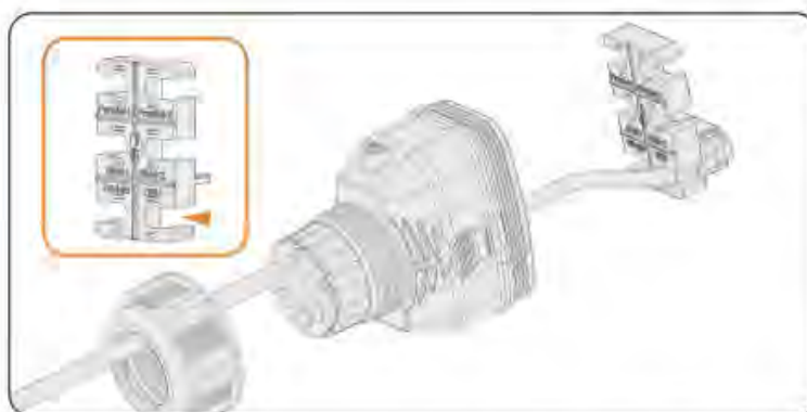
Obrázek 8-47 Instalace terminálu RJ45 do upevnění kabelu
