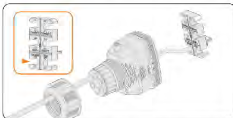
Obrázek 8-45 Instalace terminálu RJ45 do upevnění kabelu
