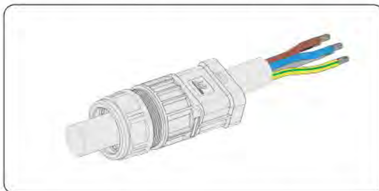
Obrázek 8-10 Procházení kabelu sítě
